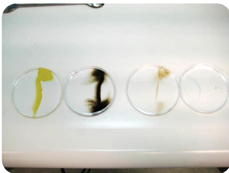
Figuur 2. Kleurige neerslag van zouten bij de diffusieproef. Van links naar rechts loodjodide, loodsulfide, kopersulfide en koperhydroxide.
