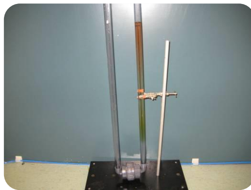
Figuur 5. Foto's van de waterverplaatsing als gevolg van osmose. Als kleurstof is universeel indicator toegevoegd. Links startsituatie en rechts na verloop van tijd.
