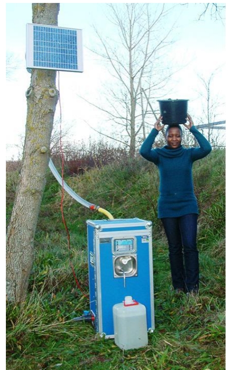
De mobiele waterzuiveringsinstallatie weegt 20 kilo en werkt op zonne-energie.
