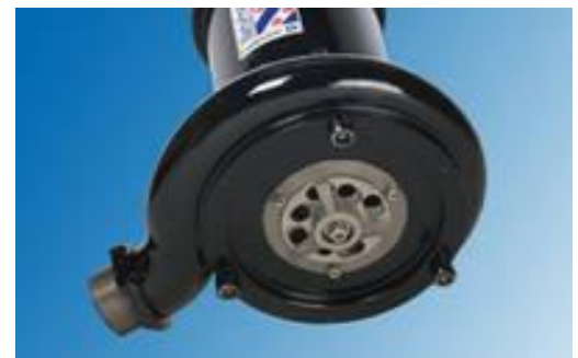
Onderaanzicht van de Wetterfretter. Drie mesjes draaien met razende snelheid over de inlaatopeningen.
